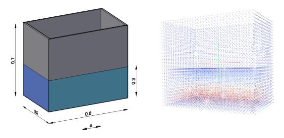
Fig. 8 Tank dimensions
