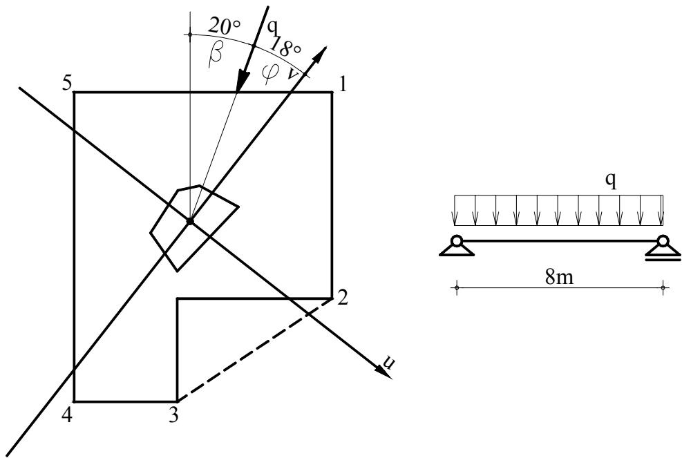
$$\beta = 20^\circ \text{ - otklon opterećenja od vertikale}$$
