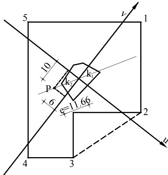
$$\text{te izmjerene vrijednosti uvrstiti u formulu: } \sigma = \frac{P}{A} \pm \frac{P \cdot e}{A \cdot k_{1,2}} = \frac{P}{A} \left( 1 \pm \frac{e}{k_{1,2}} \right)$$
