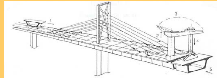
Konzolni postupak s kosim zategama preko pomoćnog stupa
