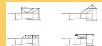
Shematski prikaz konstrukcija pokretnih postolja za konzolno građenje
