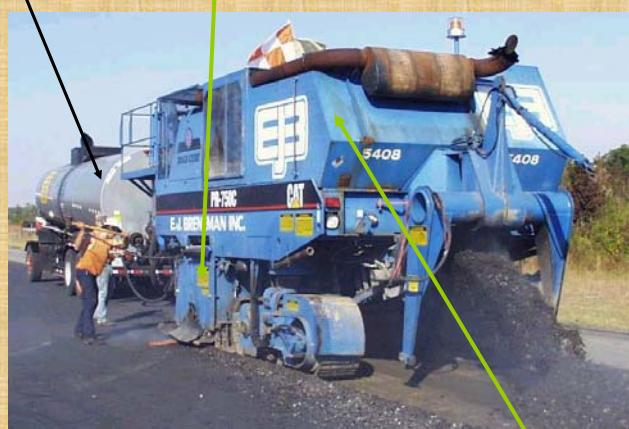
Prerađivač asfalta kolnika hladnim postupkom: **cestovna glodalica** u koju je ugrađen sklop za uštrcavanje hladnog tekućeg veziva s priključkom na cisternu. ispred glodalice nalazi se cisterna.
