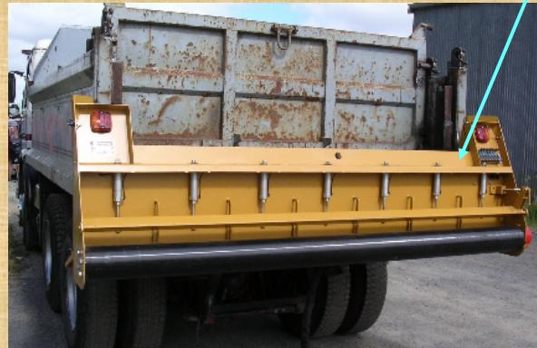
**MALI RASPRŠIVAČ BITUMENA 500 litara**
